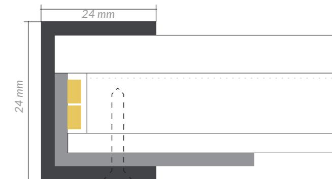
\*Detalle marco aluminio exterior de 2 mm de espesor.
