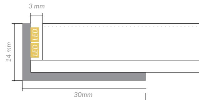
\*Una separación de 3 mm entre el metacrilato y las paredes interiores del marco permiten la instalación de las luces LED.
