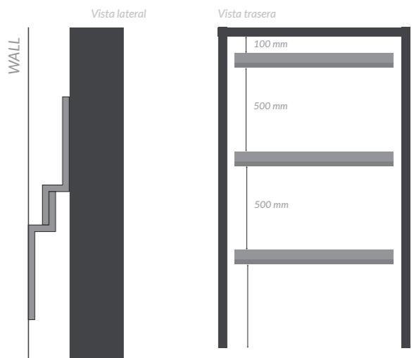
\*Se recomienda la instalación de los herrajes con una separación máxima de 500 mm.
