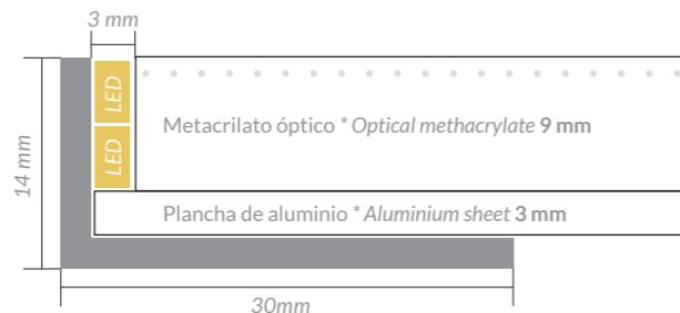
\*Una separación de 3 mm entre el metacrilato y las paredes interiores del marco permite la instalación de las luces LED.
