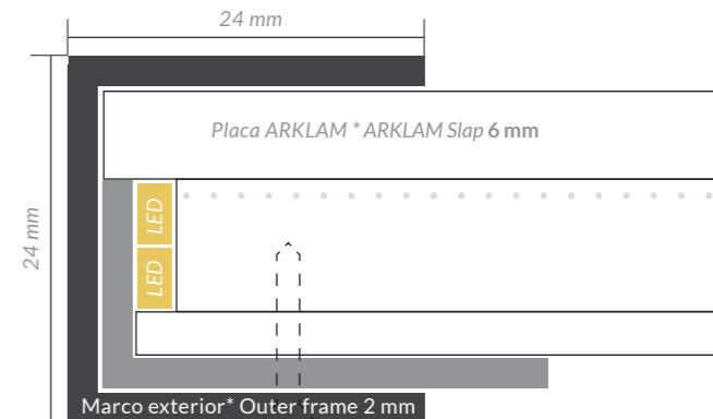
\*Detalle marco aluminio exterior de 2 mm de espesor.
