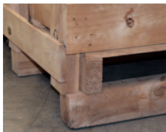
Renforcement longitudinal/ Refuerzo longitudinal
